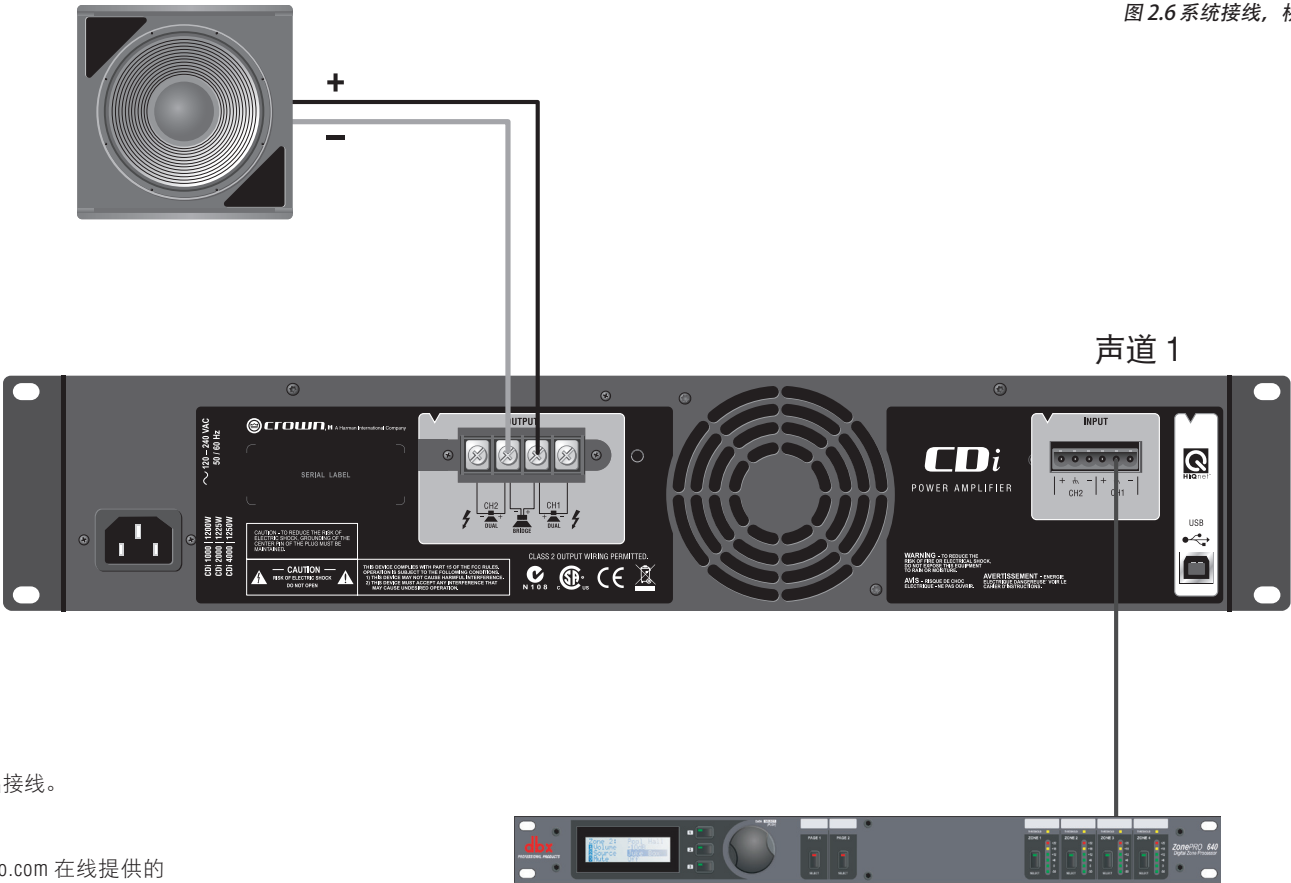
图 2.6 系统接线，桥接单声道模式
