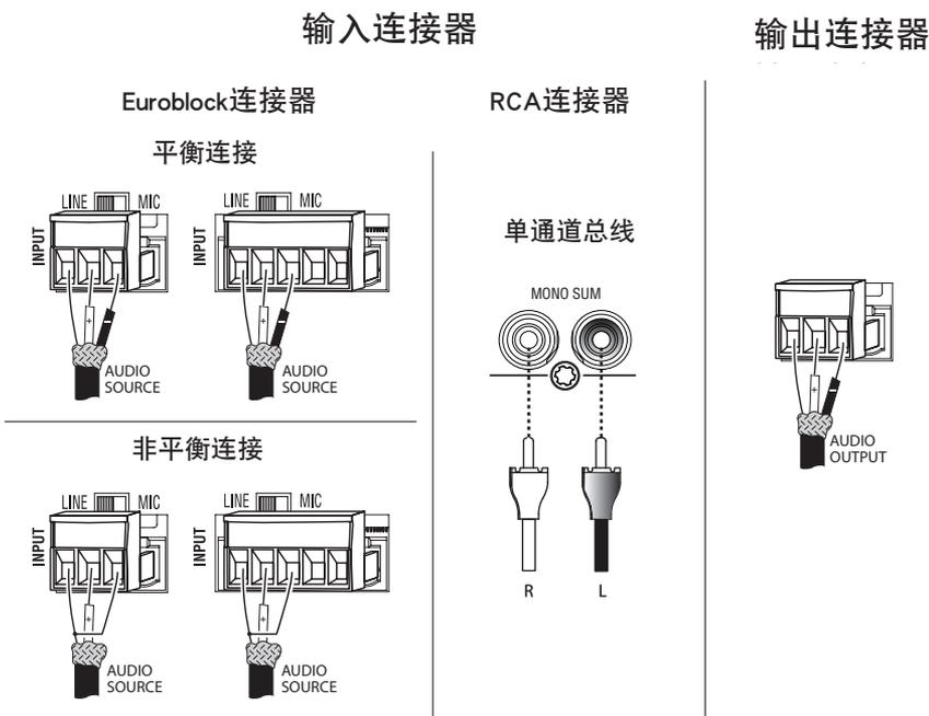
注意：同一输入通道的两路RCA连接器可将立体声输入的左右声道混合一起。
