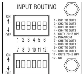
两路通道模式，CSM 2输入路径的默认将CH1至CH4的输入发送到OUT 1，CH5至CH8的输入发送到OUT2。用户也可以通过设定DIP开关，将任何输入发送到所选取的混音器。例如，如果您将开关1设定到ON，那么CH1输入信号将发送到OUT 1和OUT2。
