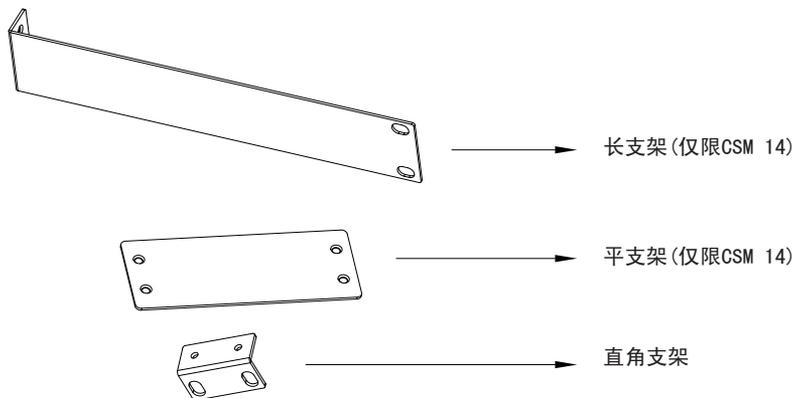
图2.2.3 安装两个半机架尺寸混音器到机柜
