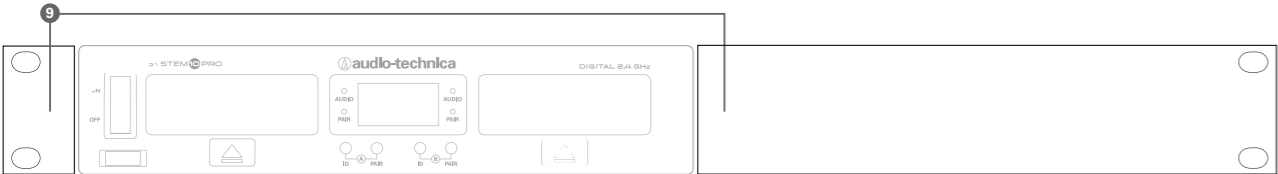
图C — 机架安装支架
